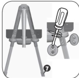
15. Insérer la **partie basse du pied arrière** dans la **partie haute du pied arrière**. La partie incurvée du pied doit être tournée vers le haut. Fixer à l'aide de **2 écrous** et **2 boulons** en insérant les **2 écrous** par le dessus.
