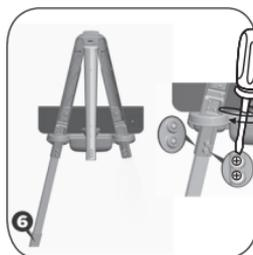
14. Insérer la **partie basse du pied avant (7)** dans le **connecteur 2**. La partie incurvée du pied doit être vers le bas et le chiffre 7 doit être tourné vers vous. Fixer à l'aide de **2 écrous** et **2 boulons** en insérant les **2 écrous** par le dessous.
