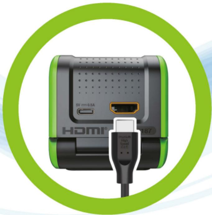
Insérer le **câble HDMI** à l'arrière de LeapMove<sup>MD</sup>.
