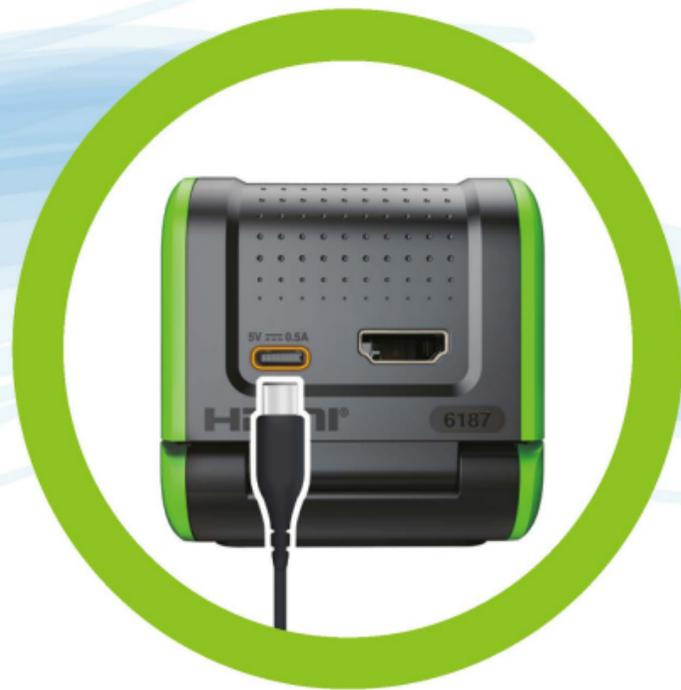
Insérer la petite extrémité du **câble USB** à l'arrière de LeapMove<sup>MD</sup>.
