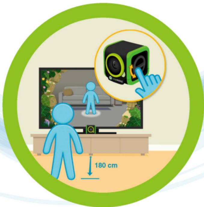
Ajuster l'angle de la console avec la molette pour que le corps entier soit visible
